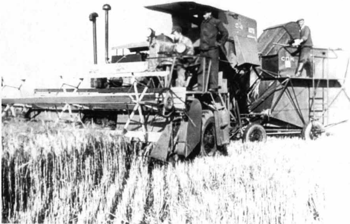
Bild 19 Mähdrescher Stalinez 4 (S 4) mit Stroh- und Spreusammelwagen
