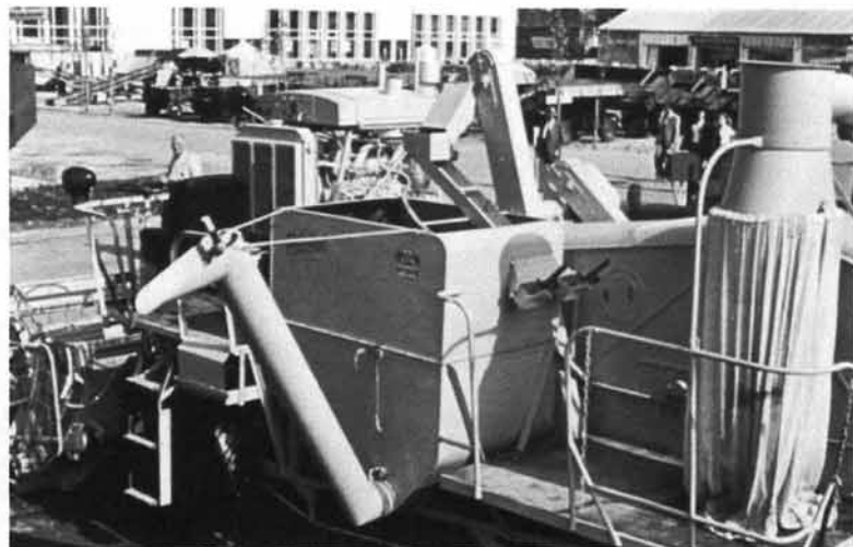
Bild 27-2 Mähdrescher E 175 in kombinierter Bunker- und Absack-Variante ohne Sortierzylinder und mit Spreuabsackeinrichtung
