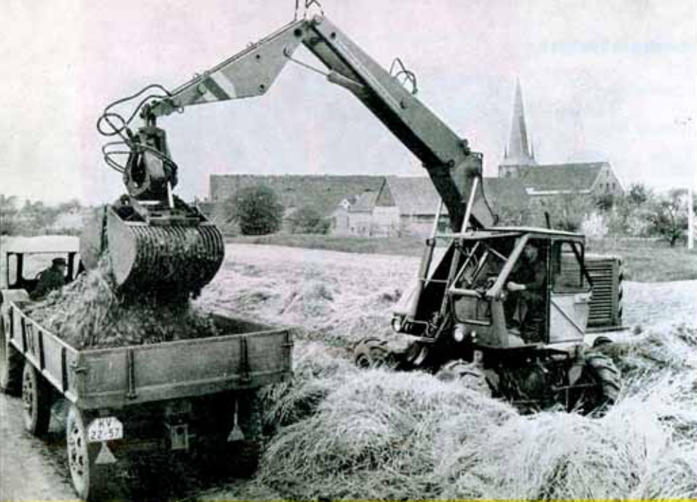
Möbilkran T 174 mit Greiferkorb bei der Mietenentleerung
