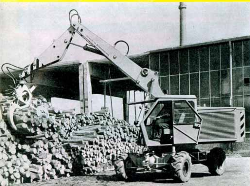
Möbilkran T 174 mit Holzgreifer beim Stapeln von Holz
