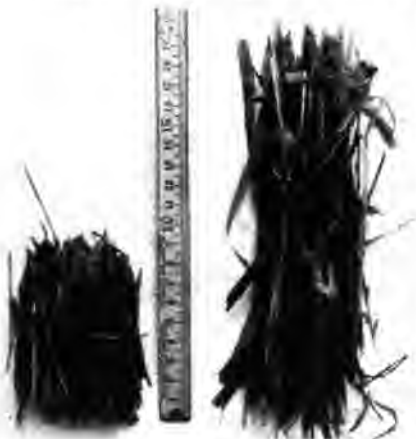
Bild 1. Vergleich der Häcksellängen; Serienausführung und Variante Langguthäcksel des E 281
