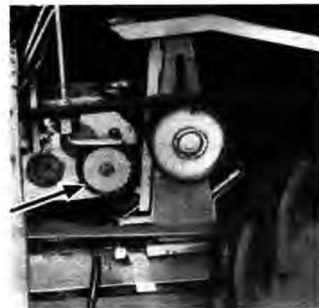
Bild 2. Ausgetauschtes Kettenrad für die Einzugsorgane
