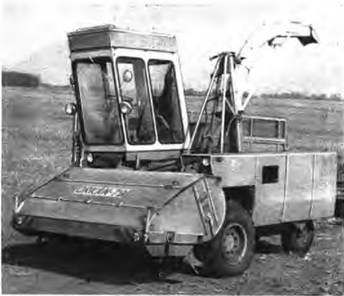
Bild 3 Feldhäcksler E 281 mit Schlegeladapter ORKAN 79 zur Rest- pflanzenernte (Foto: Hänel)
