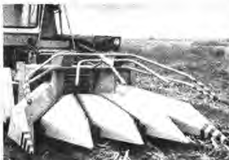
Bild 2. Maisgebiß SKA-24 am Feldhäcksler E 281 (Foto: Hille)
