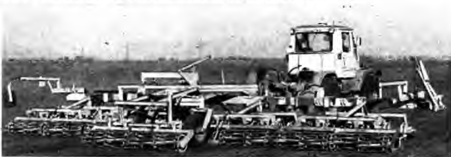
Bild 8. Kopplungswagen T 890 mit Saatbettbereitungswerkzeugen B 610 (Foto: Krüger)
