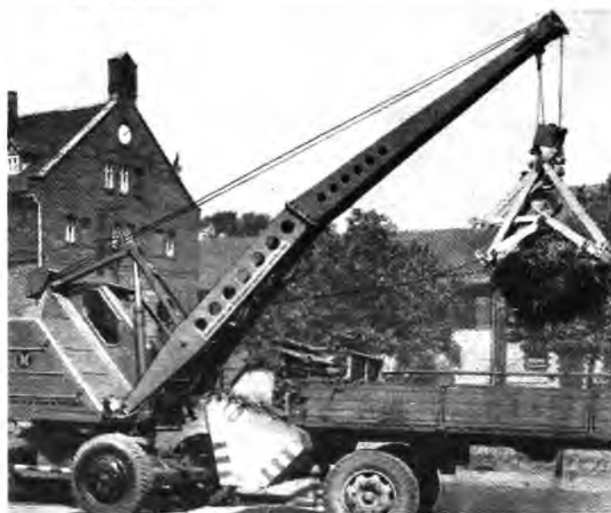
Bild 2. T 172 beim Laden von Stallung auf Mehrzweckanhänger mit angebauter Streueinrichtung
