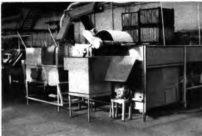
Bild 2 Schwimmkanal mit Blattaustragevorrichtung in der Kooperativen Einrichtung Apfellagerung Fahrland
