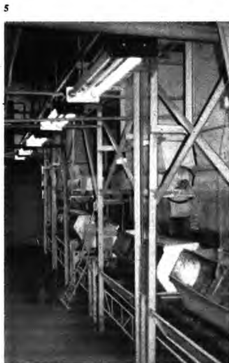
Bild 5 In Reihe aufgestellte vier Schälblöcke TS20 in der ALV-Anlage für Speisekartoffeln Löcknitz (Bilder 2, 4 und 5: H. Meilicke)
