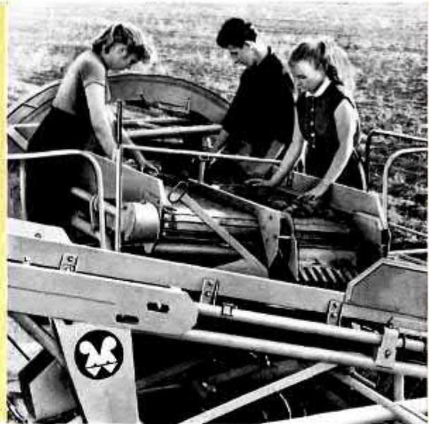
Diese mechanische Trennung der Kartoffeln vom Fremdbesatz wird von 2 bis 4 Arbeitskräften je nach Bedarf durch Handsortieren ergänzt, so daß nur gute, gereinigte Kartoffeln auf den rechts von der Maschine fahrenden Transportwagen gelangen.
