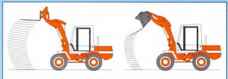
Optimal dem Arbeitsvorgang angepaßt, werden durch eine besondere Kinematik die Radlader-Werkzeuge automatisch geführt.
