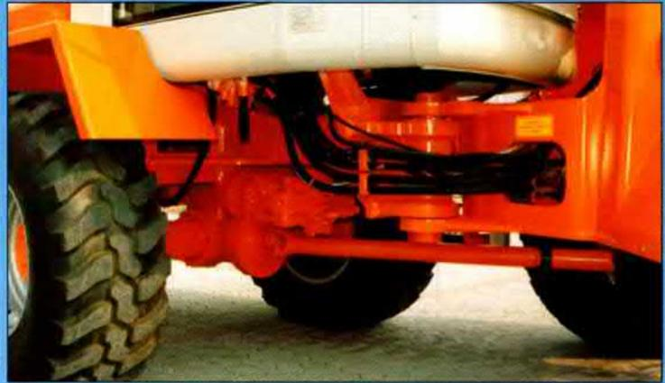
Knickgelenk und Achsenpendelung ( $\pm 12^\circ$ ) gewährleisten eine optimale Geländegängigkeit.
