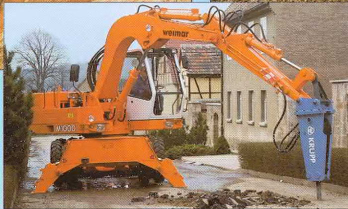
weimar M 1000 Aufbrucharbeiten Hydraulikhammer
