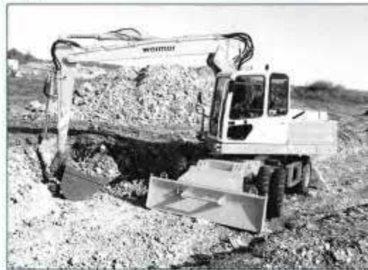
Der Mobilbagger M1000B (11 t) wird in einer Rad- und einer Raupenversion angeboten.
