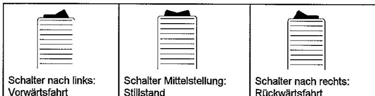
Fig. 6-5 Fahrtrichtungsschalter
