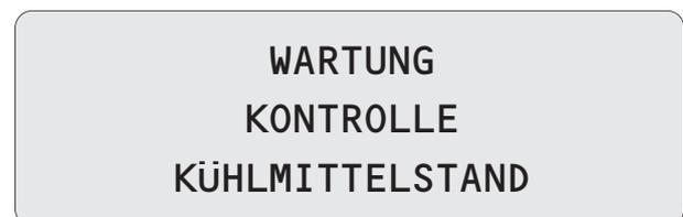
Nach durchgeführter Wartung Punkt mit den Tasten ▲▼ anwählen und durch Druck auf die Taste ► in mindestens einer halben Sekunde die Meldung löschen.
