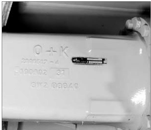
Abb. 14 Achsennummer vorn/hinten
