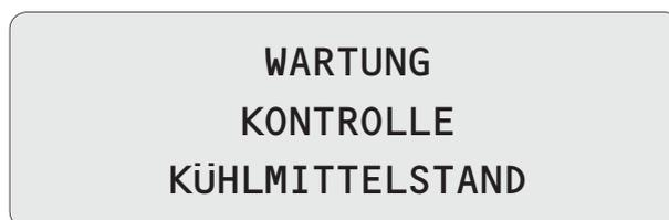
Nach durchgeführter Wartung Punkt mit den Tasten ▲ ▼ anwählen und durch Druck auf die Taste ► in mindestens einer halben Sekunde die Meldung löschen.
