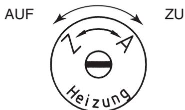
2. Luftdüsen Fußheizung. Schließt man die Düsen, kommt die Warmluft an den Luftdüsen der Frontscheibe 1 Abb. 19 heraus.
