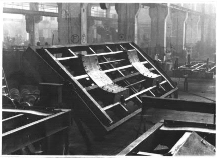
Untergestell in Schweißvorrichtung
