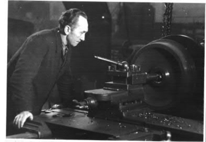
Radscheiben bei der Bearbeitung
