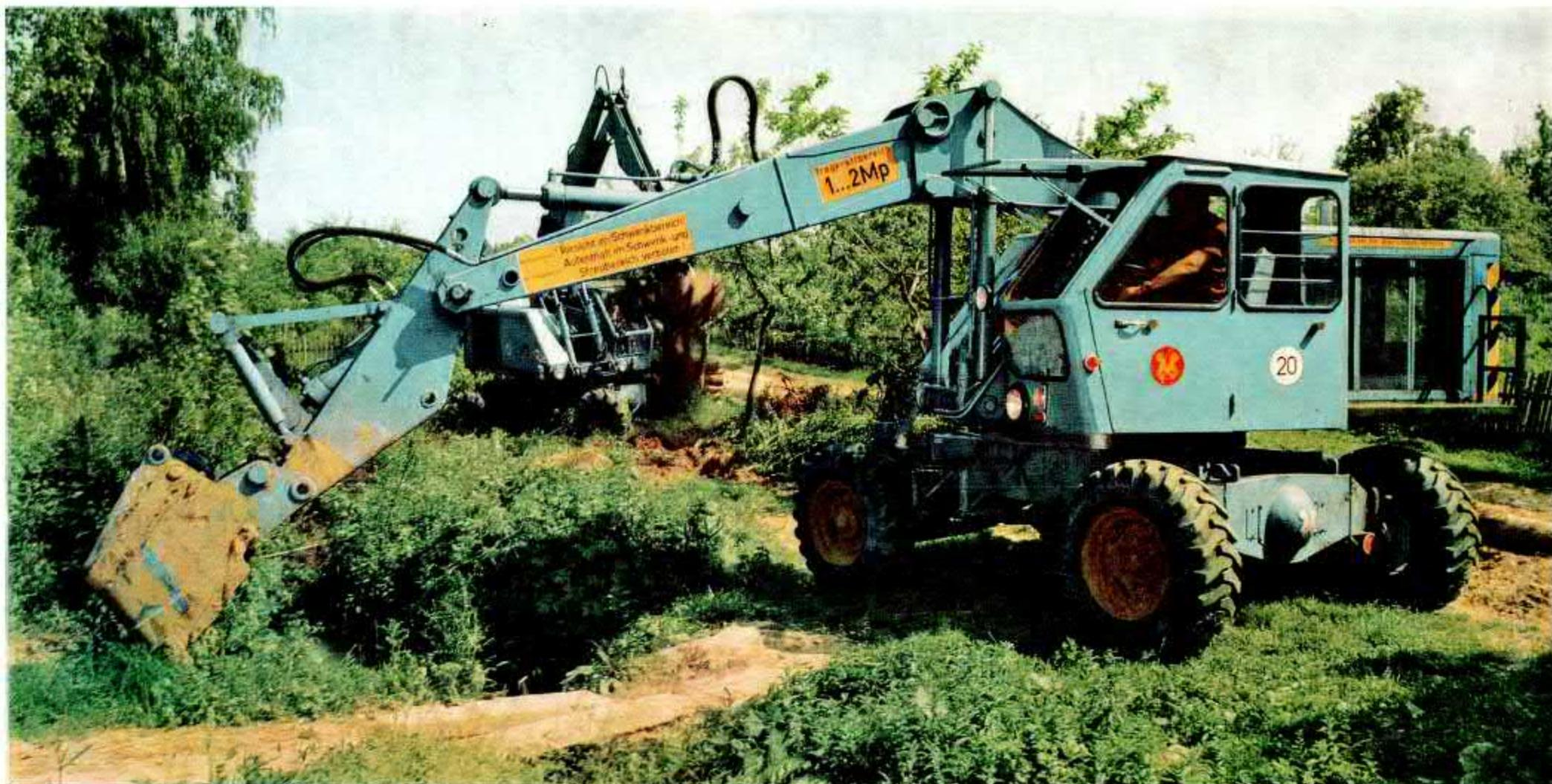
Mobilkrane und Mobilbagger der Typenreihe T 174-1 basieren auf einem einheitlichen Grundgerät, das dem beabsichtigten Verwendungszweck entsprechend ausgerüstet wird.
