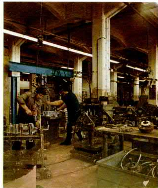
Herstellung von Finger- gesenken auf der ECM- Anlage im Kombinat- betrieb VEB Schmiede Großhain
