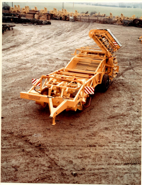
Der Leistungsfähige dreireihige Kartoffelernter E 684 ist ein Erzeugnis für das Inland und den Export in die UdSSR.
