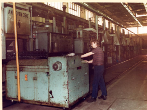
Mehrzweckkammerofenanlage zur komplexen Wärmebehandlung von Getriebeteilen und anderen hochbeanspruchten Teilen unserer Erzeugnisse
