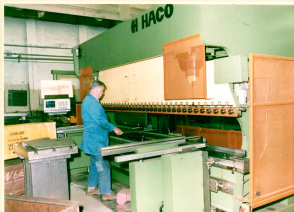
Die CNC-gesteuerte Abkante der Firma HACO (Belgien) ermöglicht mehrere Abkantungen mit einer Einstellung.
