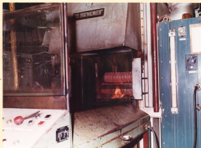
Mehrzweckkammerofenanlage zur komplexen Wärmebehandlung von Getriebeteilen und anderen hochbeanspruchten Teilen unserer Erzeugnisse
