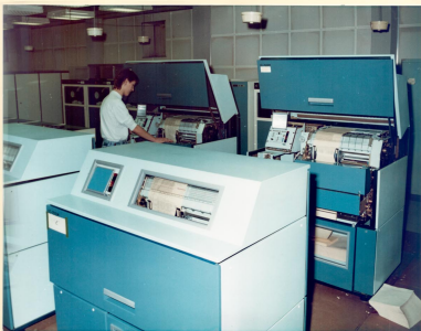
Zentralrechner ESER 1055, 2 Stück dieser Anlagen arbeiten im Betrieb
