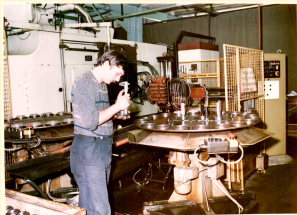
Rundtischdrehautomat im Betriebsteil Bad Sulza
