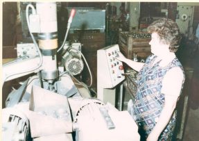
Spezialisierte Drehmaschinen im Betriebsteil Buttstädt in der Fertigung von Kupplungsaußenrücken für die KFZ-Industrie
