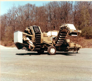
Der zweireihige hochleistungsfähige Kartoffelernter E 686 ist ein absolutes Spitzenmodell unserer Maschinen.
