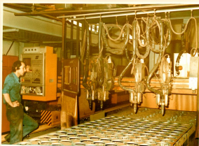
Plasmaschneidanlage zum Ausbrennen von Kettenradrunden Universale Heimwerkerholzbearbeitungsmaschine 480 aus der Konsumgüterproduktion des Betriebsteiles St. Egidien
