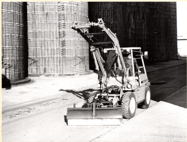
Unser drittes Finalerzeugnis ist die Stallarbeitsmaschine HT 140. Sie ist ein effektives Transportmittel für Stall und Hof.
