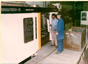
Plastspritzmaschine KUASY 800 zur Herstellung von Trägern und Mitnahmestützen für Trög- und Förderketten
