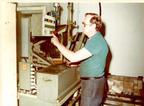
Automat zur Montage von Kupplungsaußen-Sekern
