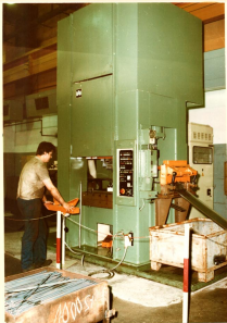
Pressenkomplex 160t zur Bearbeitung von Gehäuseteilen für Konsumgüter (Shiguli-Fanfare)
