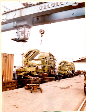
Waggonverladung von Kartoffelerntemaschinen mit Portalkrananlage
