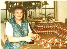
▲ Montage der Lagergehäuse für Klutenpneuwalzen ▼ Schweißen der Lenkrahmen für das einheitlich im Kombinat entwickelte Lenkrahmen
