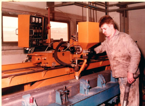
& Größteilebearbeitung von Baugruppen des Mobilkranes T 188 auf dem Bohr- und Fräswerk CBFK 150 CNC ▽ Längsnahtschweißeinrichtung für UP-Verfahren zur Fertigung der Längsträger des Mobilkranes T 174-2
